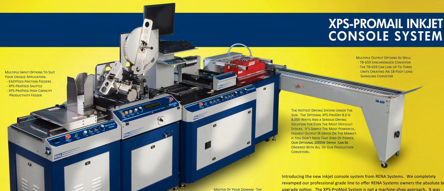
XPS-PROMAIL BASE IS A CONTROL STATION THAT GIVES A SINGLE OPERATOR FULL CONTROL OVER THE ENTIRE CONSOLE SYSTEM. IT ALSO OFFERS AUTOMATIC SPEED CONTROL, WIDE ARRAY VACUUM, & ACCUTRAK REGISTRATION GUIDES FOR PERFECT ALIGNMENT EVERY TIME.
